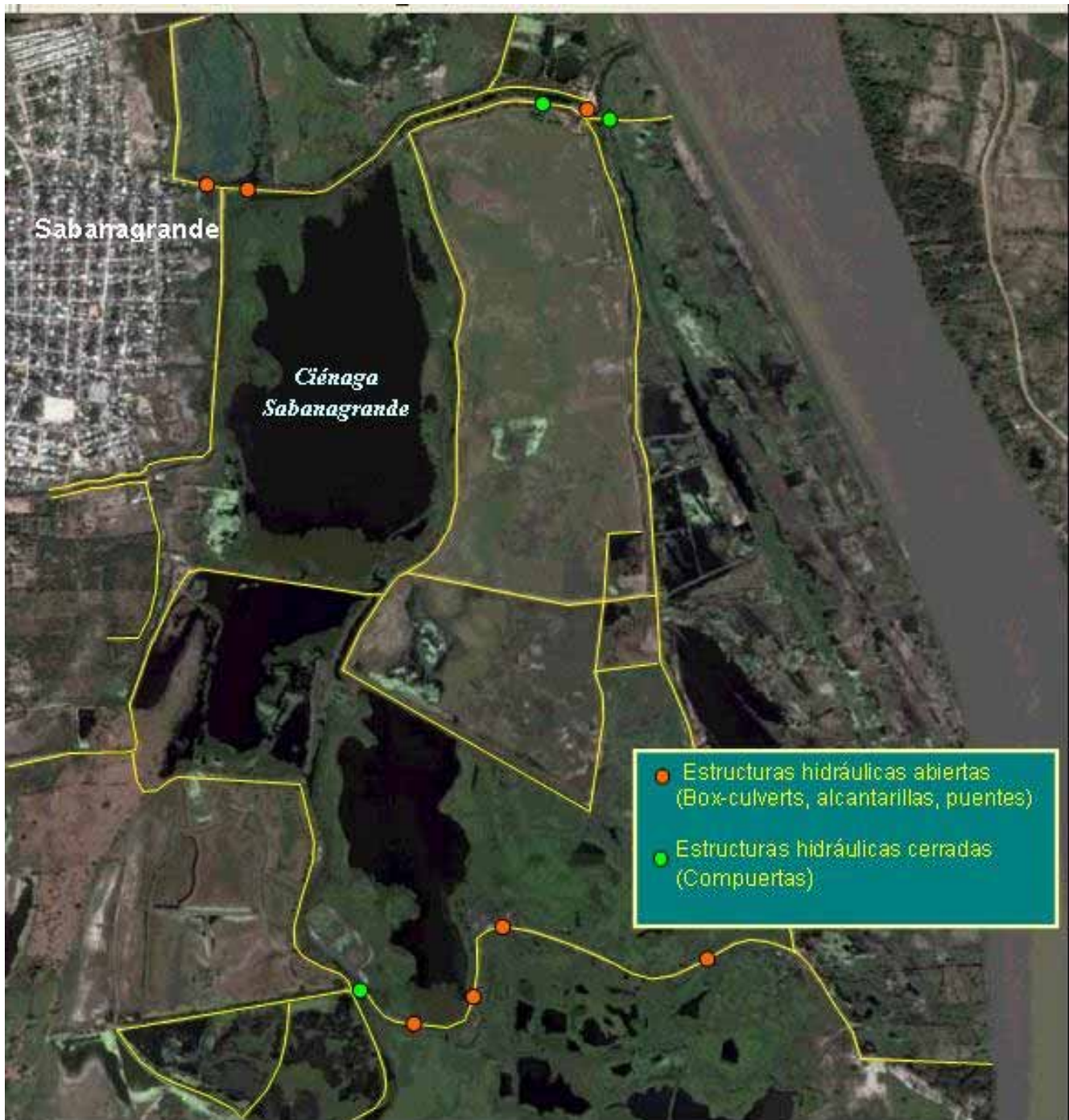
Figura 136: Obras en la ciénaga de Sabanagrande. Fuente: CI, 2007. Montaje sobre imagen de Google Earth, 2006
