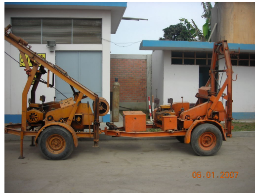
Vista N° 08.- Equipo de Balde para la limpieza de colectores.
